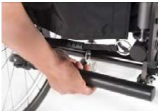
// NTR090008 Sicherheitsrad, hochklappbar
