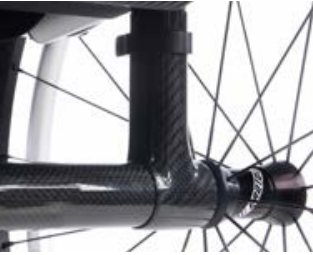
// NTR010403 Achsbaugruppe superlight, Karbon
