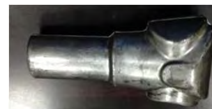
90° Rückenelement direkt nach dem Pressvorgang
