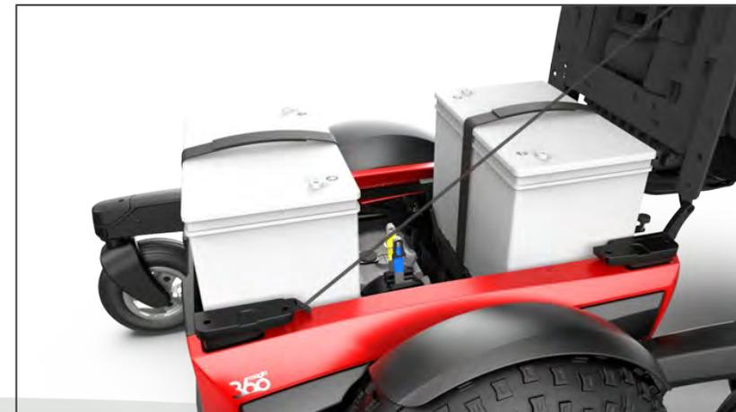
4. Entfernen Sie die Batterieverbindung und die Entriegelungshebel der Motorbremse, dann ersetzen Sie die Batterien
