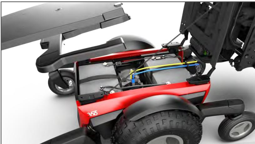
3. Klappen Sie den Sitz VORSICHTIG nach oben und entfernen Sie die Batteriefachabdeckung und die Anschlussabdeckung
