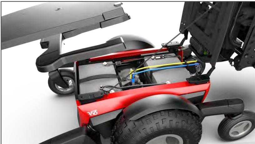
3. Vorsichtig den Sitz hochklappen und die Abdeckung des Batteriekastens und die Abdeckung der Klemmen entfernen.
