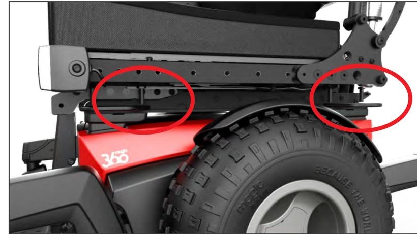
2. 8 x Befestigungsschrauben entfernen
