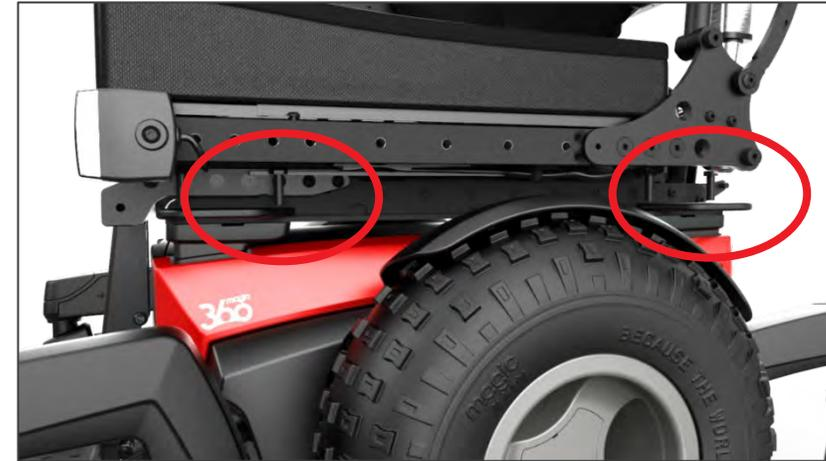
2. 8 x Befestigungsschrauben entfernen
