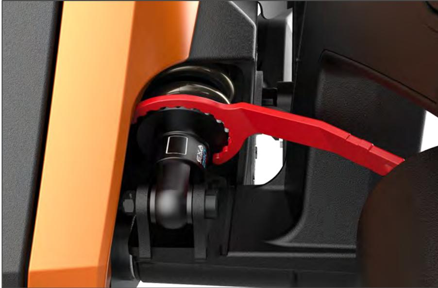
Mit dem Stossdämpferschlüssel (der sich in der Abdeckung des Powermoduls befindet) die Muttern an den vorderen und hinteren Stossdämpfern lösen oder festziehen
