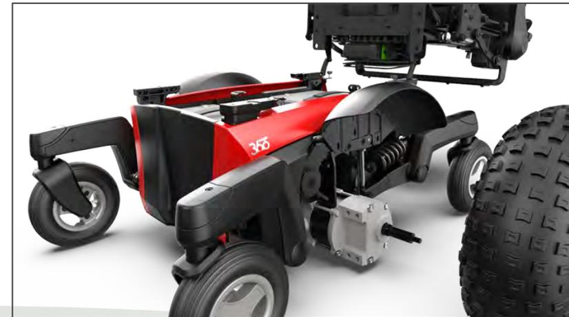
4. Antriebsräder und Motorbremslösehebel abnehmen, Motoren abschrauben und die neuen Motoren einsetzen
