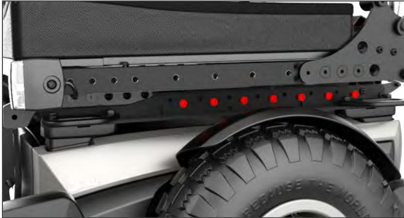
1. Seitliche M6-Schrauben entfernen
