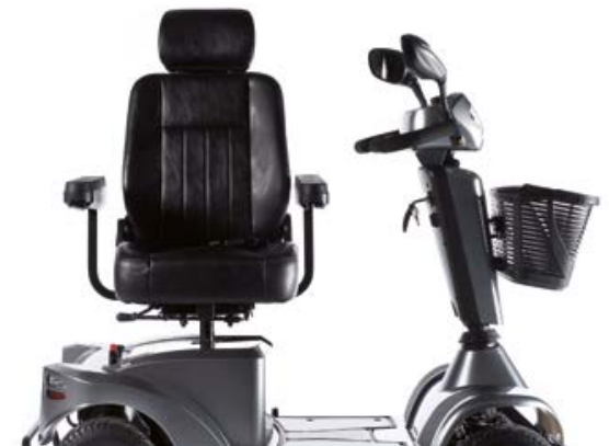
→ Sitzdrehung zur Seite ermöglicht einen besonders bequemen Einstieg
