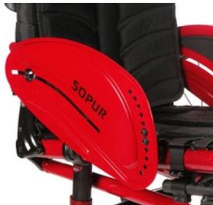
// NTR040102 Partie latérale aluminium, protection contre le froid, sans garde-boue, en couleur du châssis
